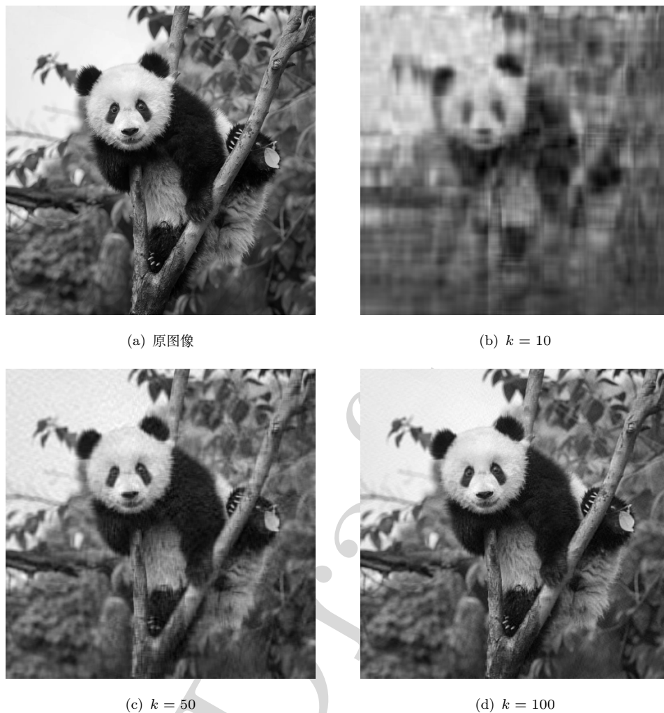
图 2.1: 基于截断奇异值分解的图像压缩
